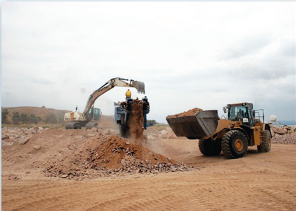
Carrière de transformation des moellons en caillasse dans la Province du Kongo-Central
